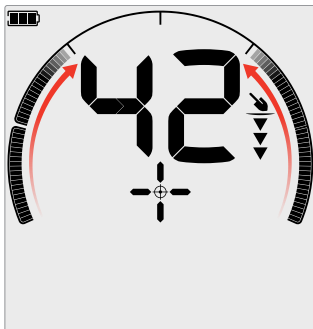
약한/중심에서 벗어난 타겟 신호: 켜져 있는 식별 세그먼트가 더 적습니다. 타겟이 코일 외부에 더 가깝게 위치합니다.
